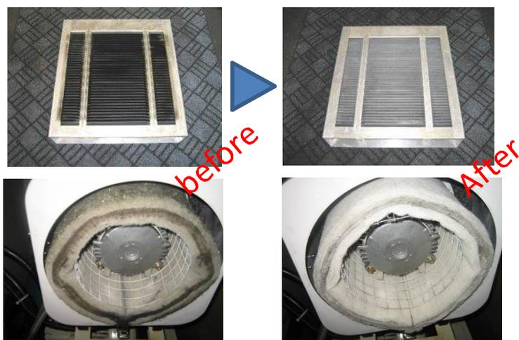
電気式ミストコレクターの極板が汚れてくると、ミストの捕集効率が下がリオン化できなかったミストは、そのまま排気されてしまいます。
