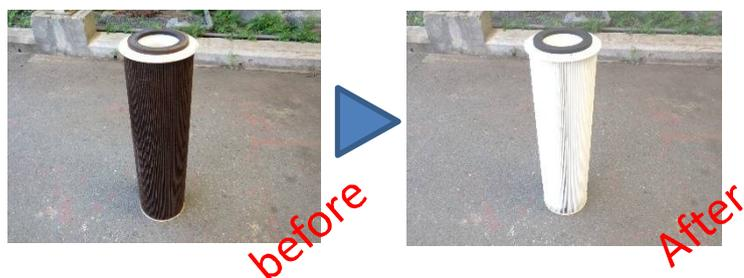
従来使い捨てられている乾式集塵機のフィルターを洗浄し、再利用できるようにします。
